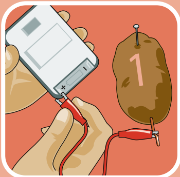
Verbind de draad van nr. 1 met de pluskant.
