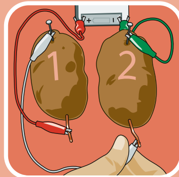
Verbind de spijker van nr. 1 met de draad van nr. 2.
